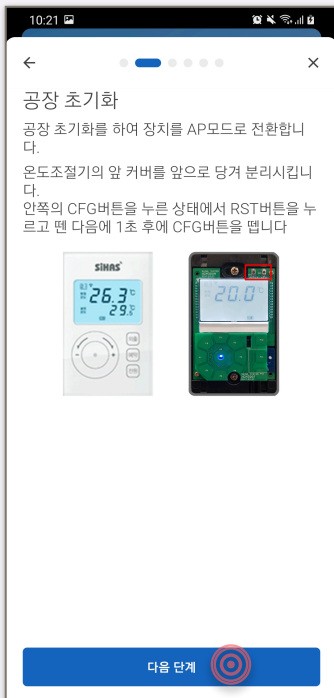
4. 화면의 설명대로 커버를 벗긴 후 CFG버튼을 누른 상태에서 Reset 버튼을 눌렀다떼고 이어서 CFG버튼에서 손을 떼면 장치가 초기화됩니다.
